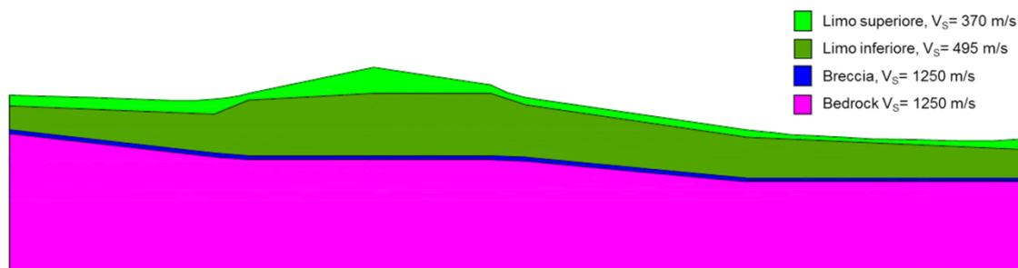
**Figura II. 28:** Modello sottoposto ad analisi con codice di calcolo FEM (F. Rotili, 2010)
