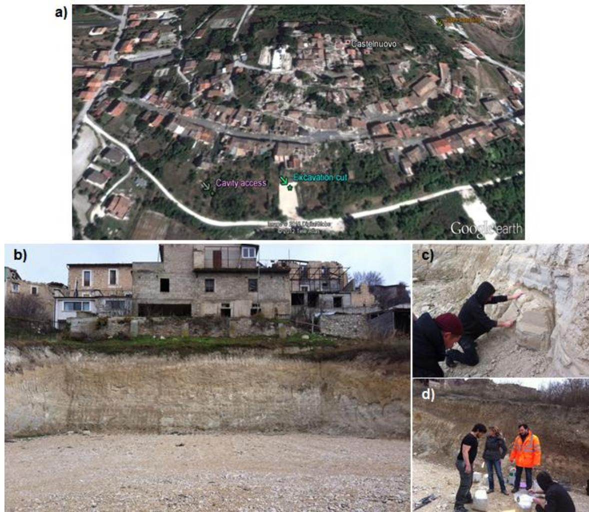
**Figura III. 1.** a) Sito di campionamento a Castelnuovo; b) fronte di scavo da cui sono stati prelevati i campioni indisturbati; c), prelievo dei bocchi; e d) sigillatura.
