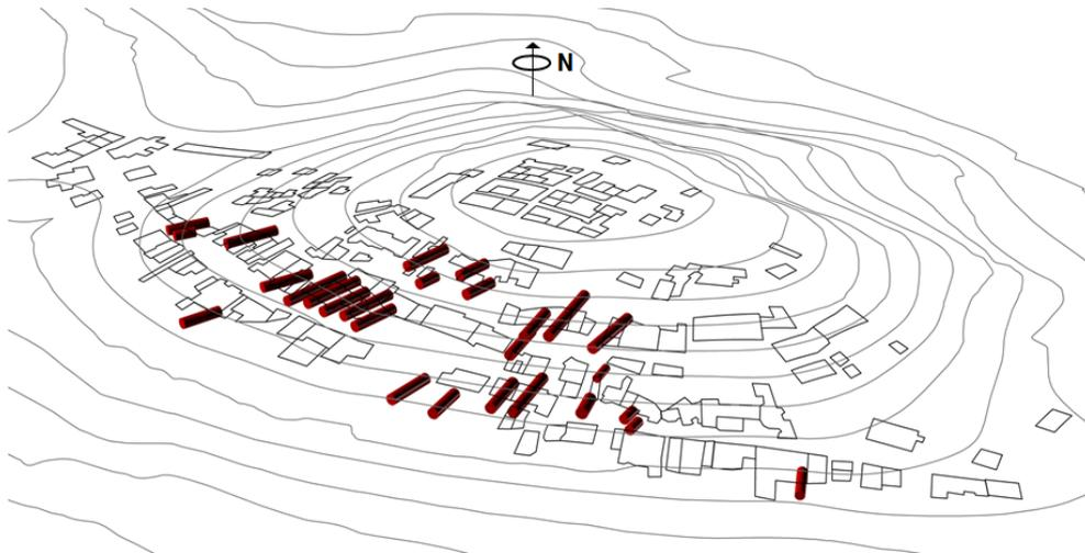
**Figura V.10.** Vista del versante Sud con evidenziate le cavità cilindriche inserite nel modello, rappresentato dalle isoipse del colle. Si riporta anche la traccia dell'edificato sulla superficie topografica.
