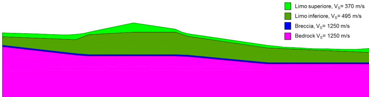
Figura I.20. Modello sottoposto ad analisi con codice di calcolo FEM (F. Rotili, 2010)
