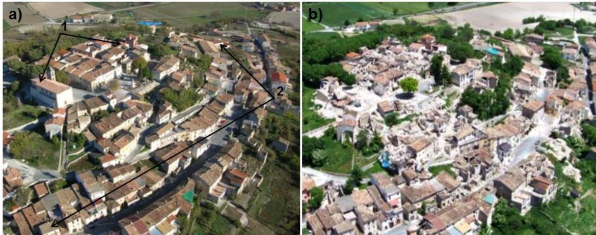
**Figura I.2.** Castelnuovo: vista dall'alto del versante Sud-Est del colle, prima a) e dopo b) il terremoto del 6 Aprile 2009. Sono indicati: 1) il nucleo del *castello*, 2) gli edifici del *borgo* costruiti tra il 1945 ed il 1985.
