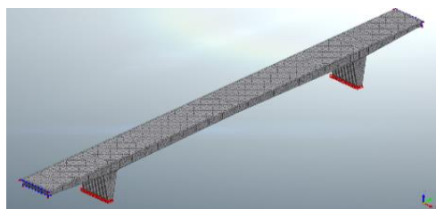
Fig 5. Modello a base fissa del ponte San Nicola generato in MIDAS FEA NX
