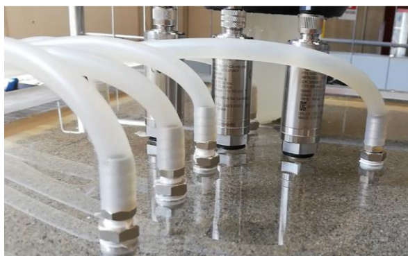
Fig. 4. Foto dell'impianto di monitoraggio delle pressioni neutre (sinistra) e schema del sistema idraulico in uscita (destra).
