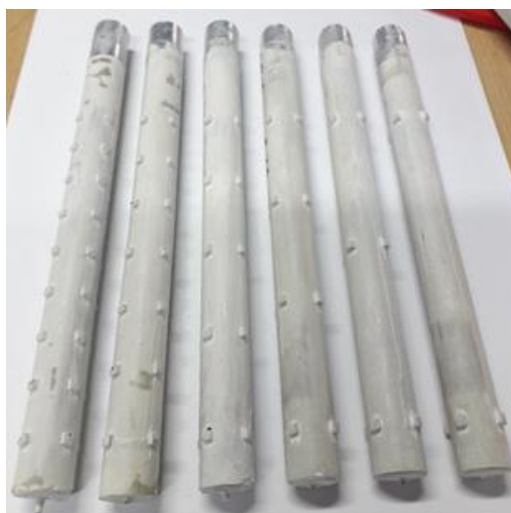
Fig 4. Alcuni dei pali modello estratti al termine della prova.
