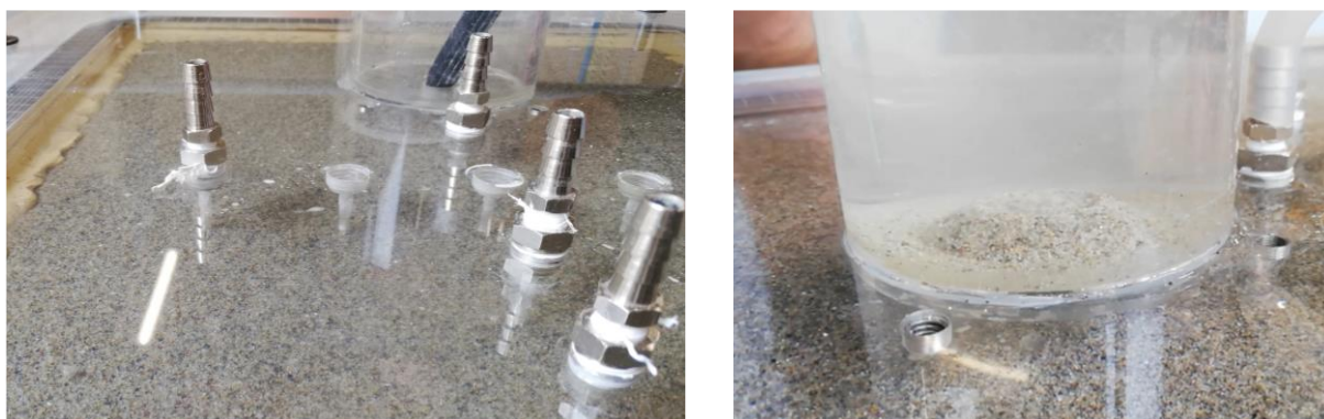
Fig 3. Dettagli della superficie superiore a contatto con la sabbia (sinistra) e del foro di uscita durante lo sviluppo di un canale di erosione.
