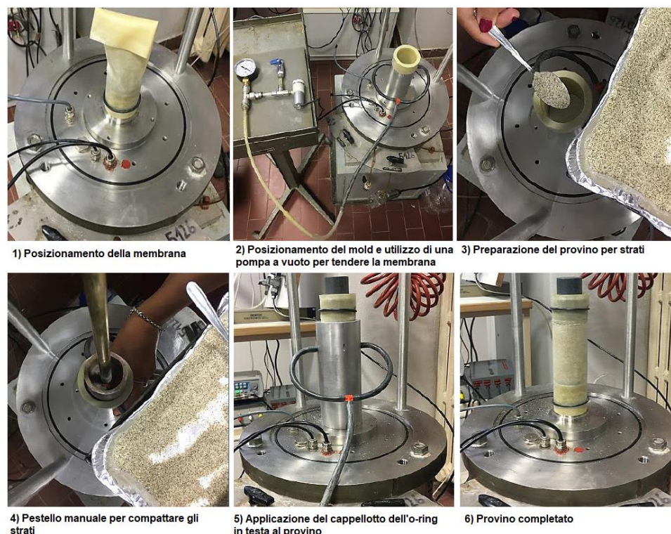
Fig 4. Preparazione dei provini di colonna risonante
